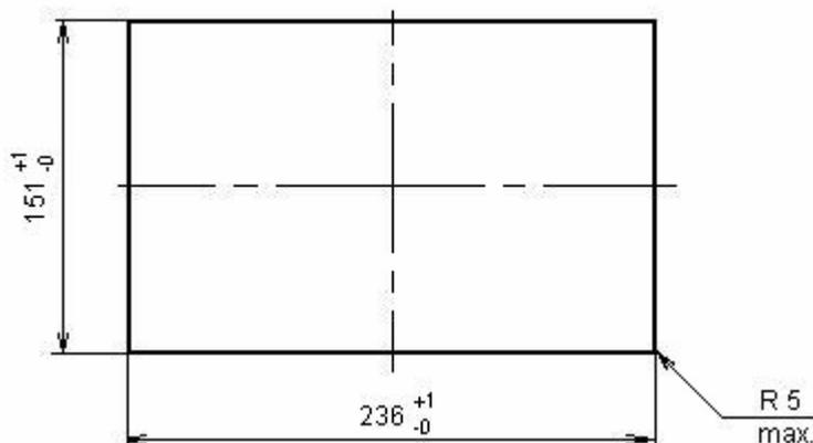
Рис. 3. Вырез в щите для установки КВУ.
