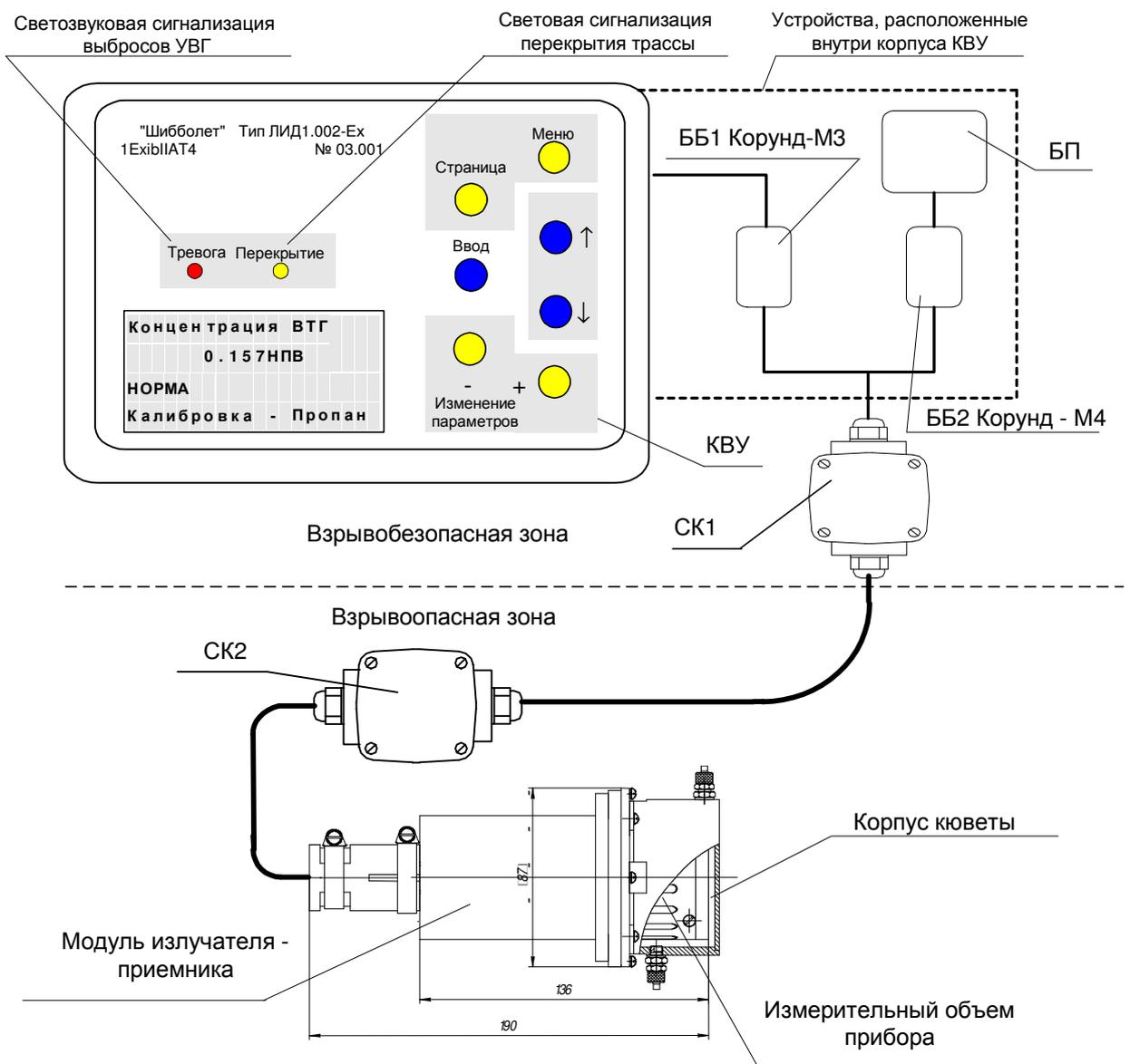
Рис.1а. Внешний вид детектора ЛИД и его структурная схема.
