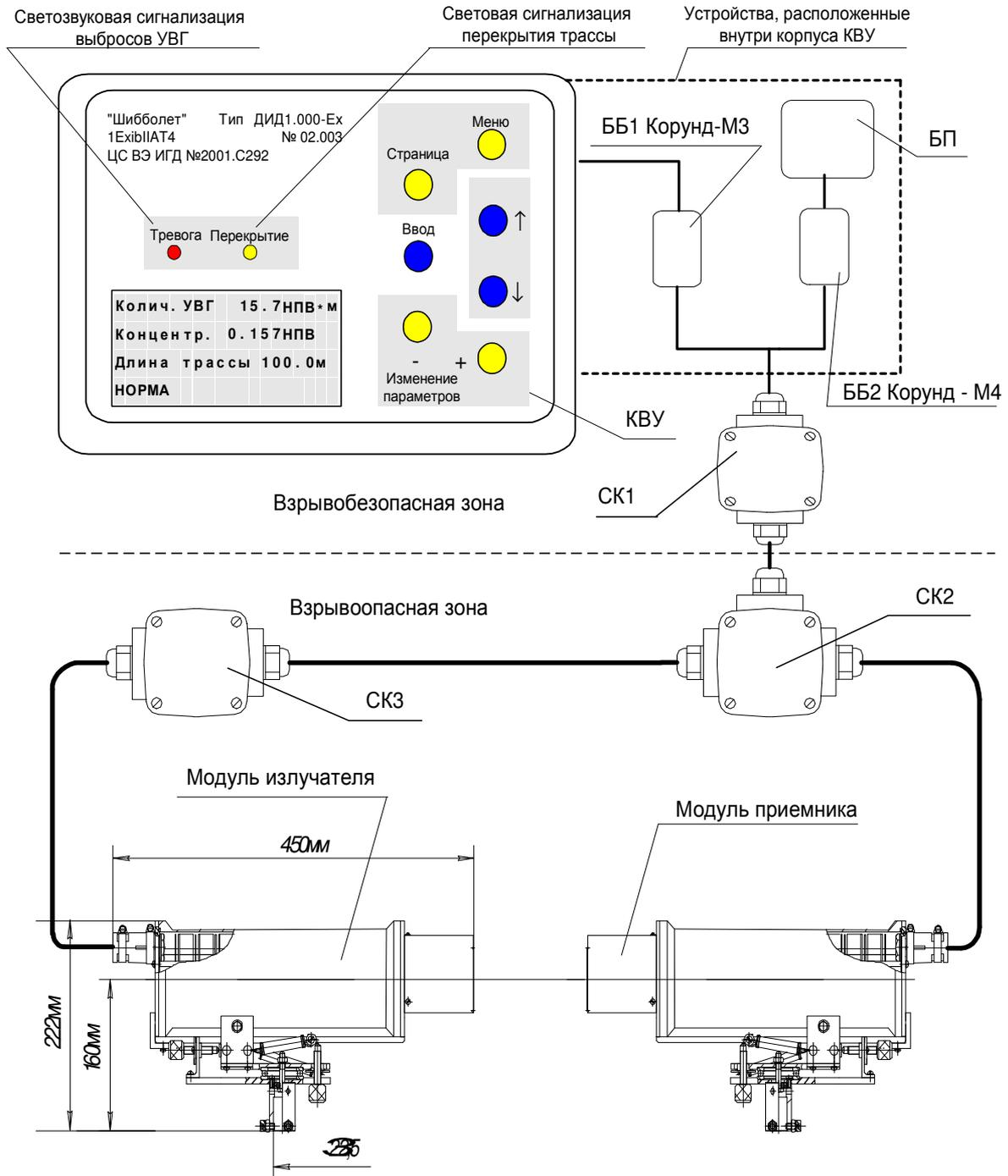
Рис. 1. Внешний вид детектора ДИД и его структурная схема.
